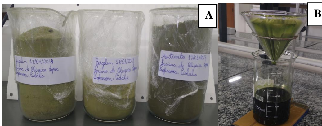
Figura 4- Material vegetal já seco e moído em liquidificador manual(A), Realização de filtração simples para obtenção de extratos foliares (B).
